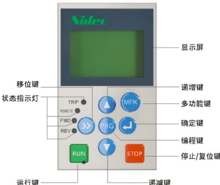
图 4-1 操作面板示意图
